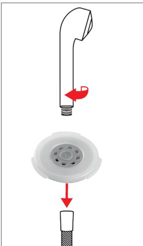
Zwischen Duscharmatur und Brauseschlauch wird der PCW-01 mit dem Gesicht nach oben im Brauseschlauch eingesetzt; zwischen Brauseschlauch und Handbrause mit der Unterseite nach oben (siehe Illustrationen).
